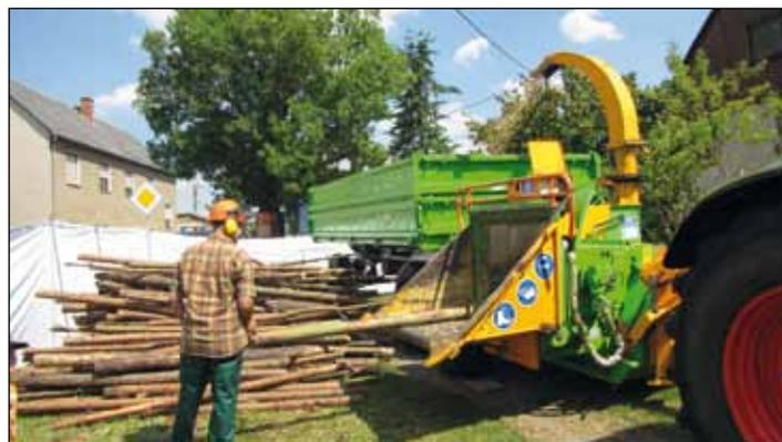
Axel Spranger aus Leubnitz demonstrierte mit gewaltiger Apparatur die Herstellung von Hackschnitzel zu Heizzwecken. Es können Stammstärken über 30 cm gehäckselt werden.
